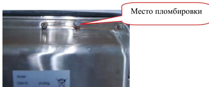
Рисунок 4 – Место пломбировки дисплея
