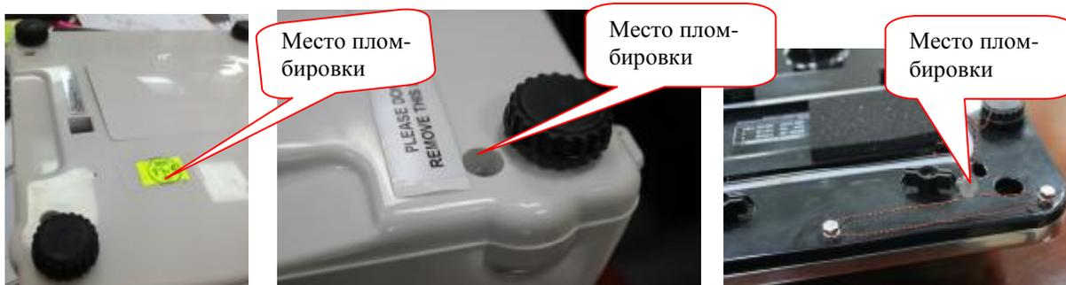
Рисунок 6 – Место пломбировки от несанкционированного доступа весов CS2010.
