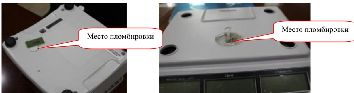
Рисунок 7 – Место пломбировки от несанкционированного доступа весов CS2011.
